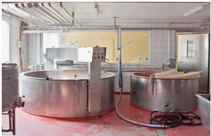
Mit dem neuen 4000-Liter-Kessel (links) ist man für die Zukunft auf der Alp Kohlschlag bestens gerüstet.
